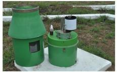
FLOAT TYPE SELF RECORDING RAIN GAUGE
