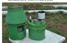
FLOAT TYPE SELF RECORDING RAIN GAUGE
